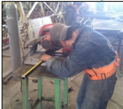
Figura 62. Medición de un tubo para cortarlo.
