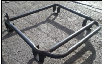
Figura 74. Estructura de la banqueta.
