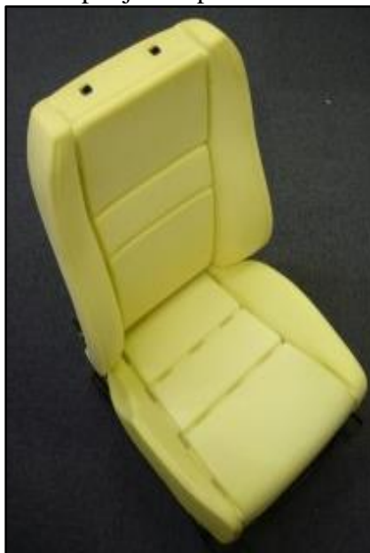
Figura 77. Esponjas de poliuretano moldeado.
