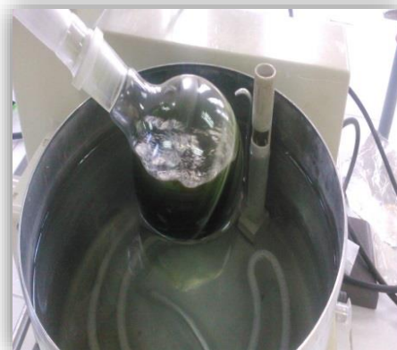
Fotografía N°4. Concentración en rotavapor de orégano orejón e insulina vegetal respectivamente
