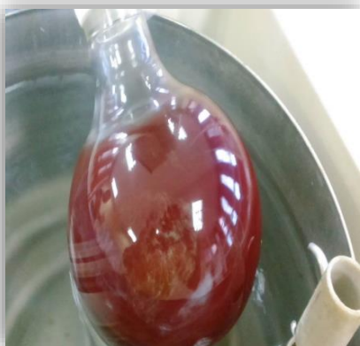
Fotografía N°4. Concentración en rotavapor de orégano orejón e insulina vegetal respectivamente
