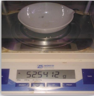
Fotografía N°1. Peso del crisol
