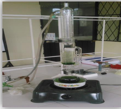
Fotografía N°3. Método de extracción por soxhlet
