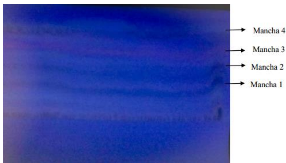
FIGURA N°2-3. Cromatografía en capa fina del extracto metanólico de Justicia chlorostachya . Fase Móvil: acetato de etilo: ácido fórmico: ácido acético: agua (100:11:11:26)
