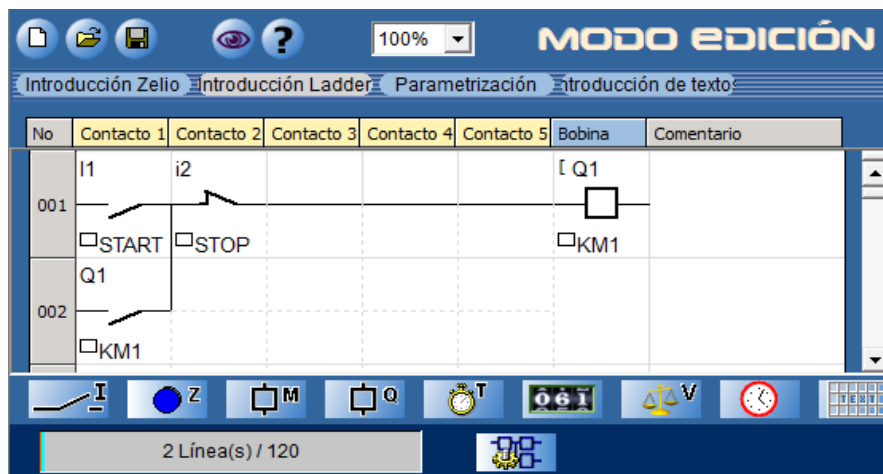
FIGURA N°33: CIRCUITO ARRANQUE DIRECTO MOTOR TRIFÁSICO. (ZELIO SOFT)
