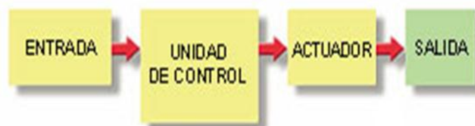
FIGURA II 2 ESQUEMA DE LAZO ABIERTO.
