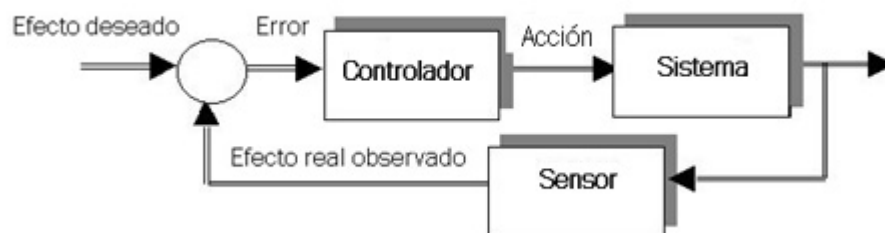
FIGURA II 1 ESQUEMA GENERAL DE UN SISTEMA DE CONTROL
