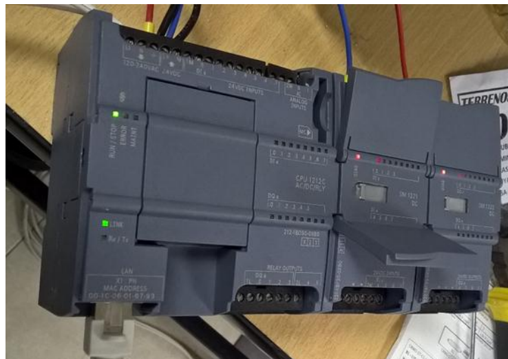
FIGURA III 59 PLC S7 1200 CPU 1212C AC/DC/RLY Y MÓDULOS DE EXPANSIÓN.
