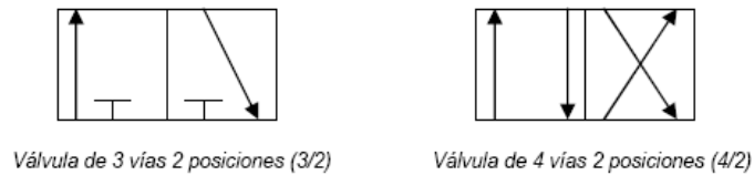
FIGURA II 27. VÍAS DE VÁLVULAS.
