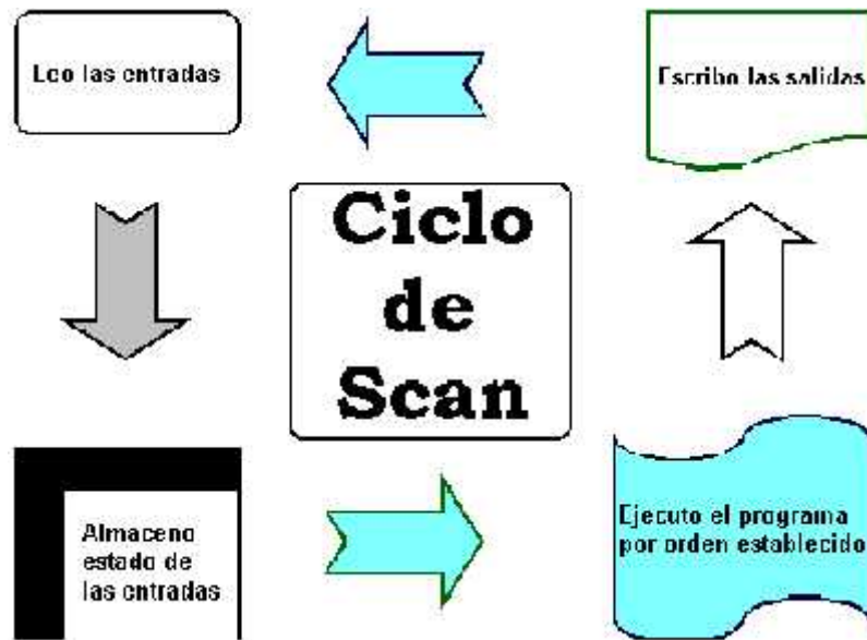
Figura II 27. Ciclo de funcionamiento de un PLC
