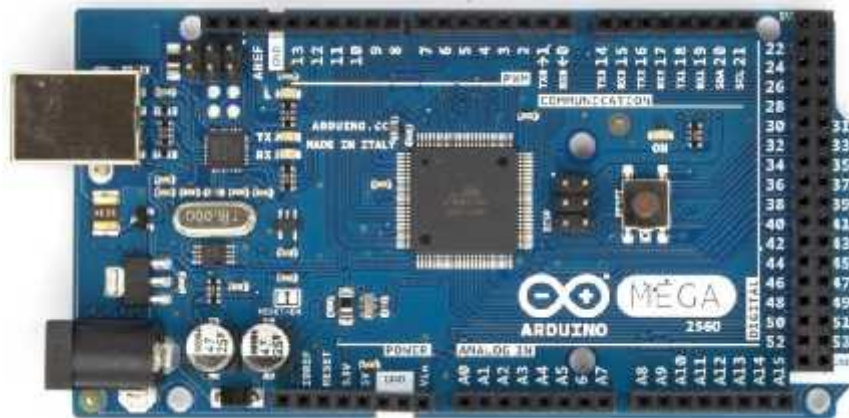
Figura III 57. Arduino Mega 2560 R3
