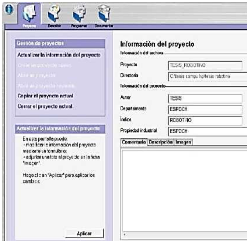
Figura III 73. Creación de nuevo proyecto Twido Soft
