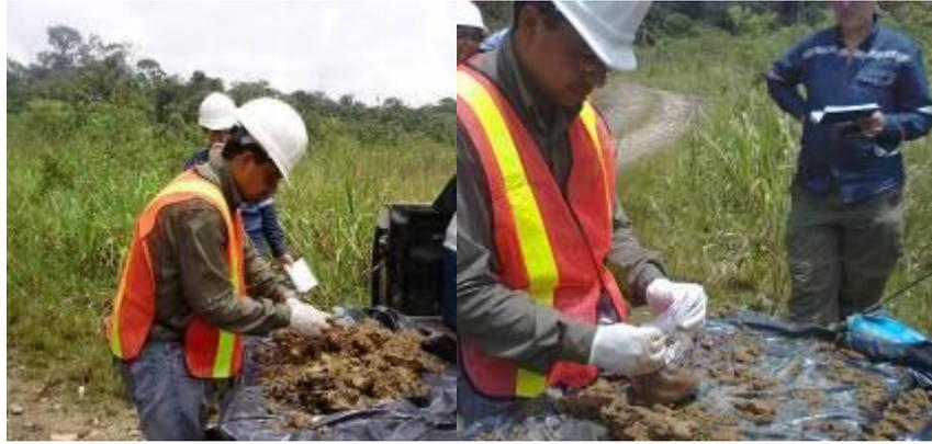
Foto 9 Preparación y embalaje de la muestra compuesta de suelo
