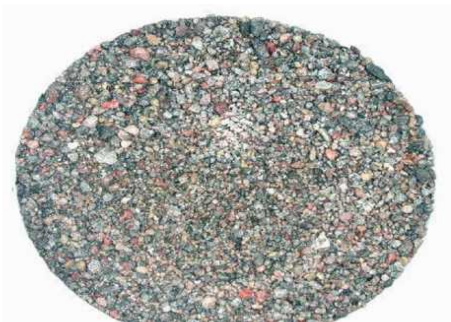
Fig. 3.8. Vista del medio filtrante de mayor grosor (grava) de la etapa primaria de filtración.
