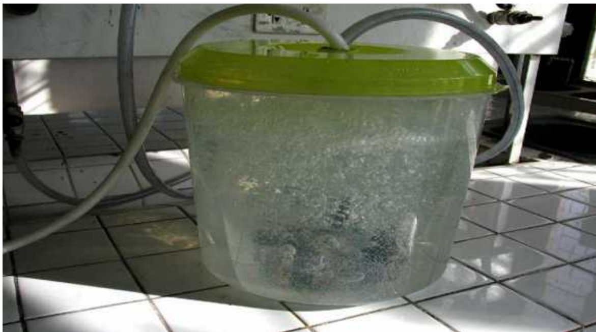
Fig. 3.9. Vista del tanque reactor donde se realiza el proceso de oxidación química mediante ozono; observándose en la parte inferior del mismo el sistema difusor de aire ozonizado.
