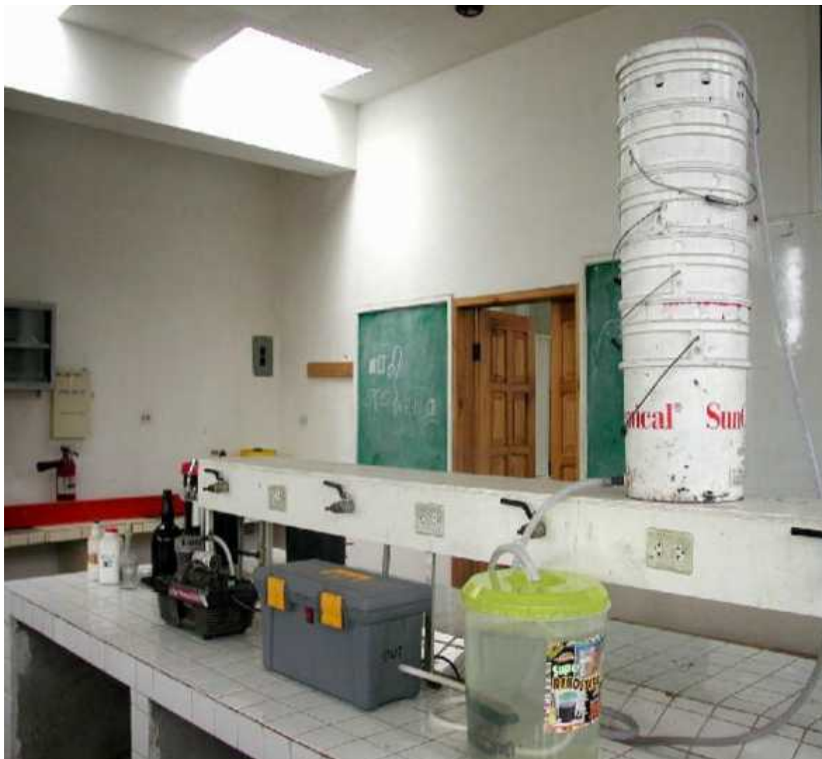
Fig. 3.11. Vista completa del sistema de tratamiento experimentado donde se aprecia el sistema de filtración ya mostrado, el tanque reactor batch en cuanto al agua servida y continuo en cuanto a la corriente de aire ozonizado, el recipiente que encierra al ozonizador, precedido por la bomba de aire que lo alimenta.
