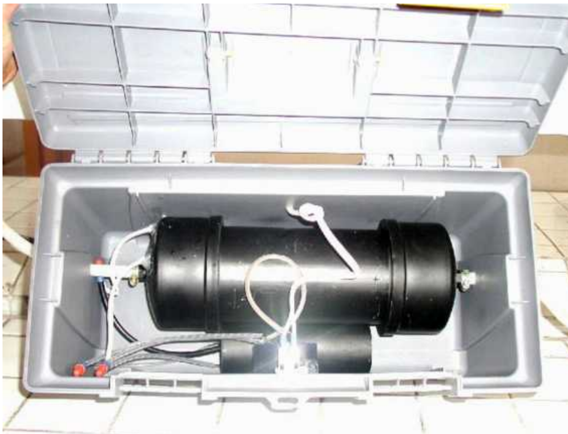
Fig. 3.12. Sistema productor de ozono, a partir de aire en este caso.
