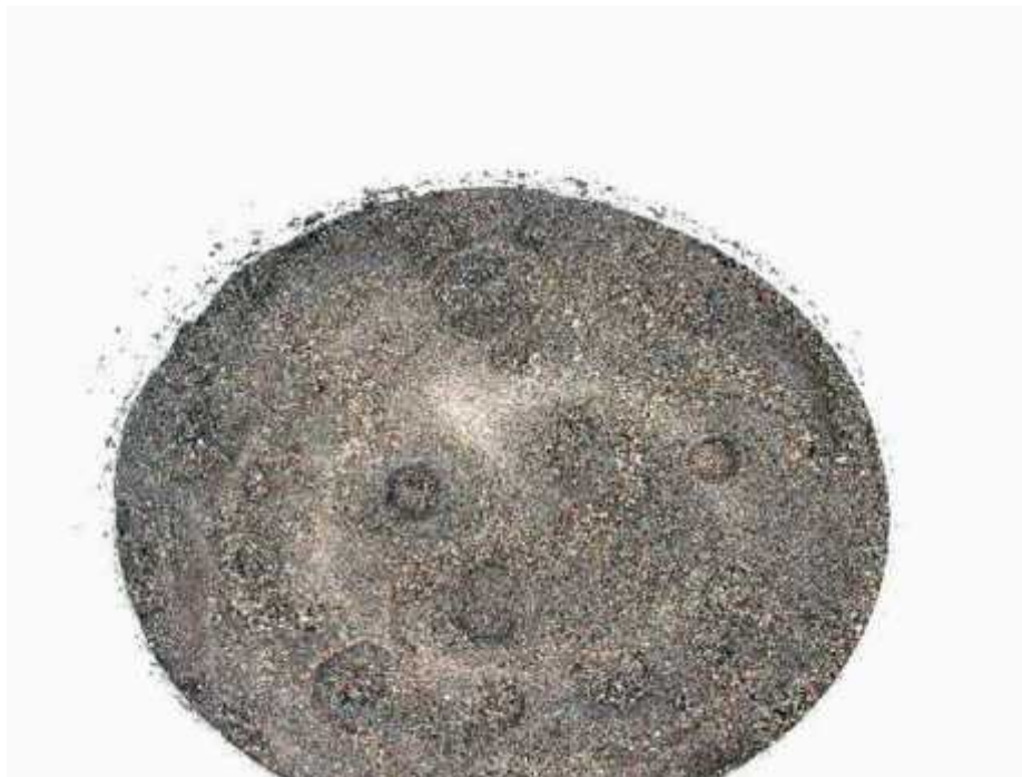
Fig. 3.7. Vista del medio filtrante de grosor medio (arena de grosor mediano) de la etapa intermedia de filtración.
