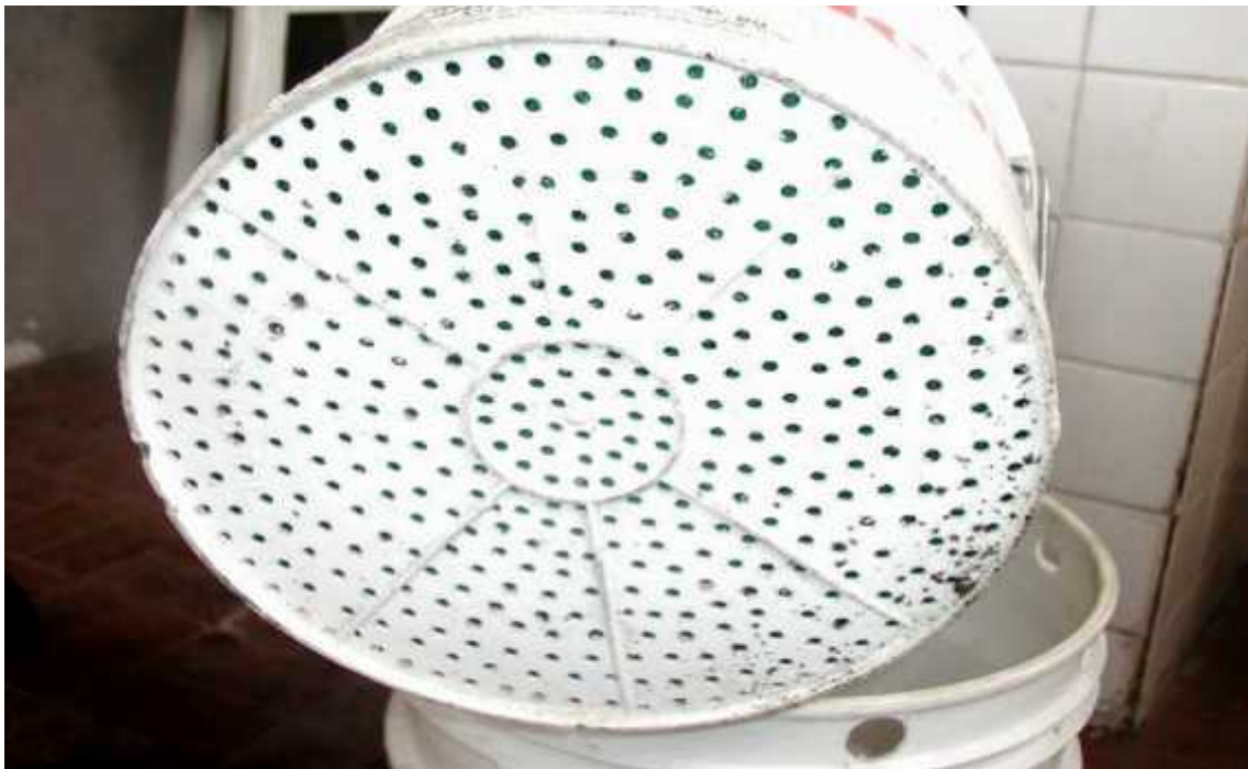
Fig. 3.5. Vista del fondo de las diferentes etapas de filtración previa a la oxidación química con ozono.
