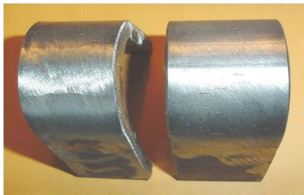
Figura 29. Ensayo de doblado lateral en espécimen de espesor 1 pulg. [25 mm]
