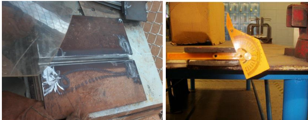
Figura 27. Corte y mecanizado de placa para calificación en campo
