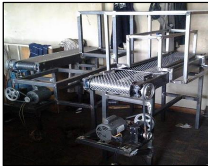
Figura 50. Construcción del sistema de transmisión
