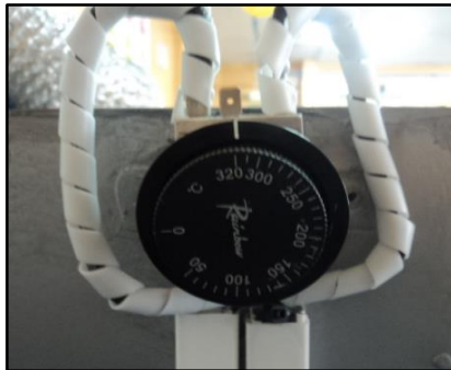
Figura 41. Controlador de temperatura
