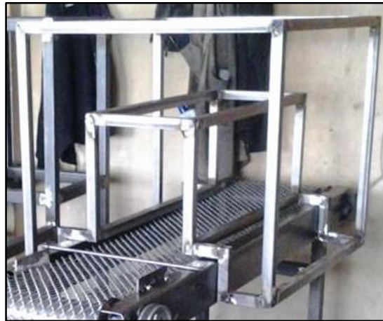
Figura 39. Estructura del túnel termoretráctil
