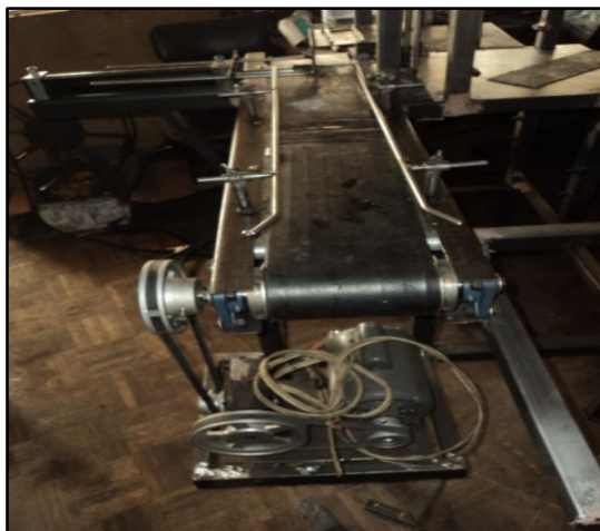
Figura 49. Montaje de rodillos
