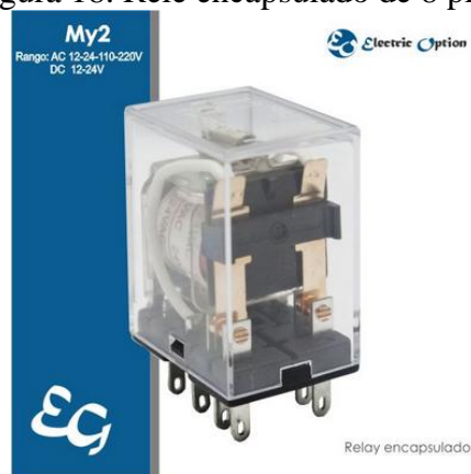
Figura 18. Relé encapsulado de 8 pines
