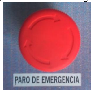
Figura 50. Paro de emergencia
