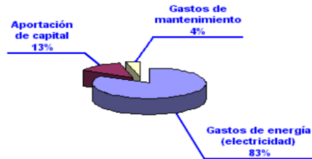
Figura 36. Gastos de una instalación de aire comprimido
