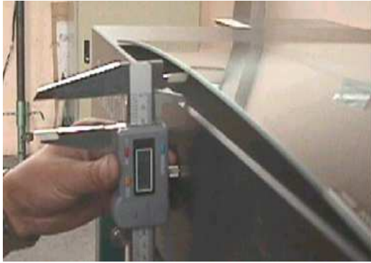
Figura 45: Medición flecha interna
