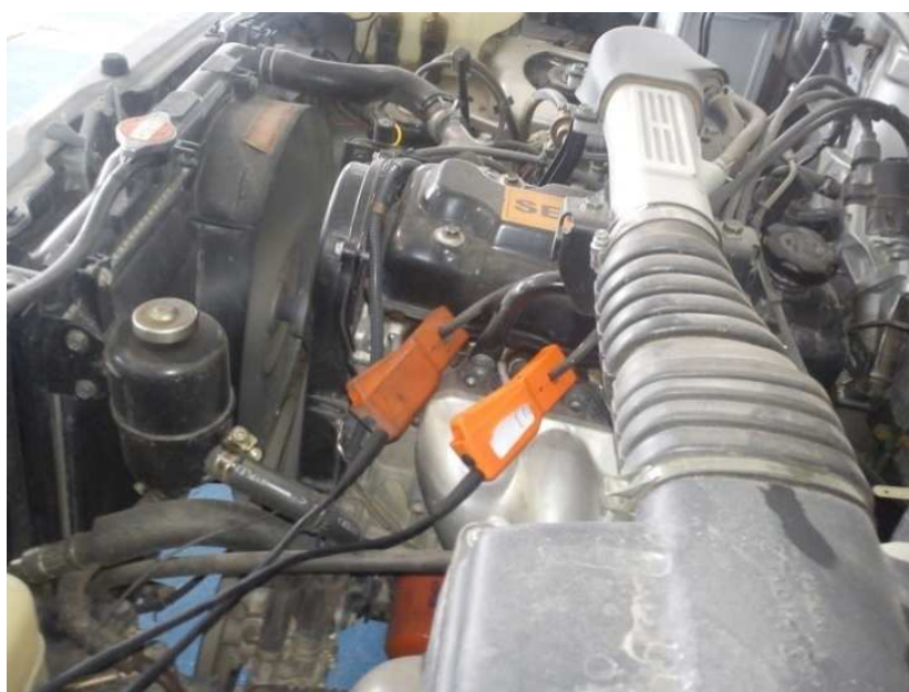
Figura 31. Instalación de las pinzas trigger
