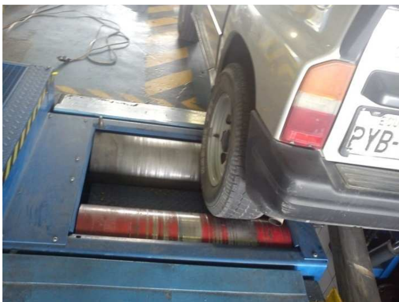
Figura 30. Colocación del vehículo en el dinamómetro
