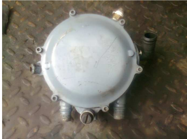
Figura 25. Reductor vaporizador de G.L.P.
