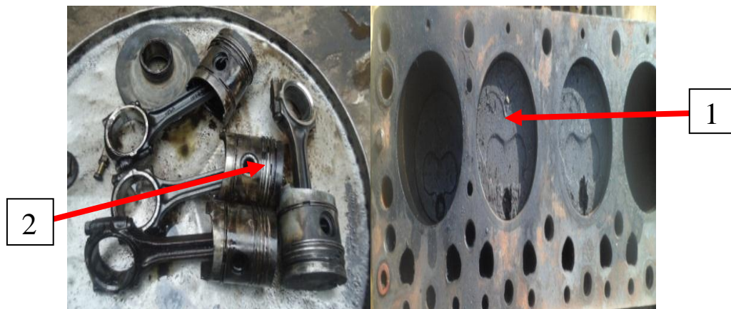
Figura 8. Émbolos y bielas en mal estado
