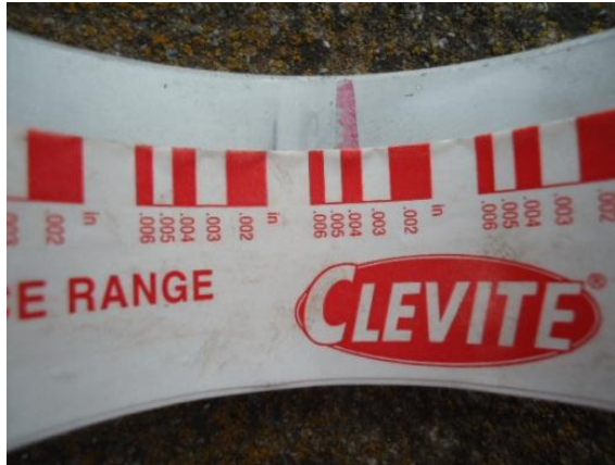
Figura 26. Holgura mediante plastigage
