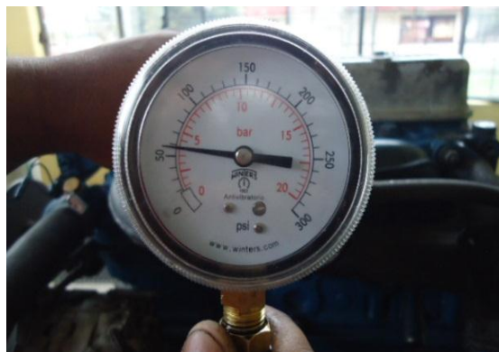
Figura 39. Presión de lubricación del turbocompresor
