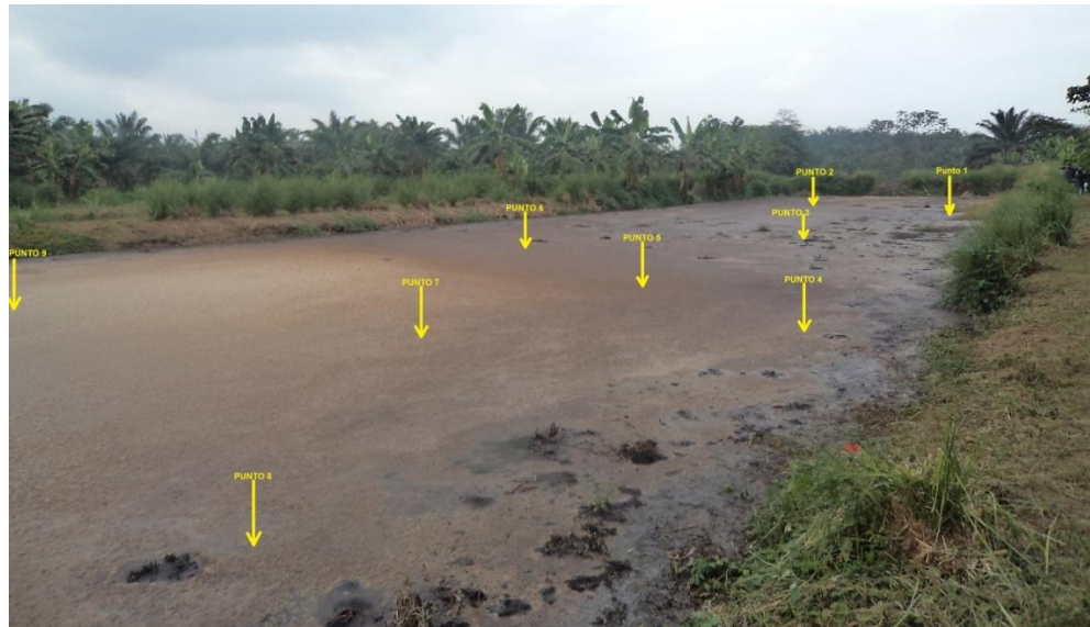
Imagen N° 2-3: Puntos de muestreo de sedimentos dentro de la Laguna de Oxidación
