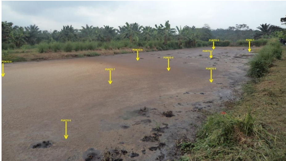
Imagen N° 2-2: Puntos de muestreo de agua dentro de la Laguna de Oxidación.
