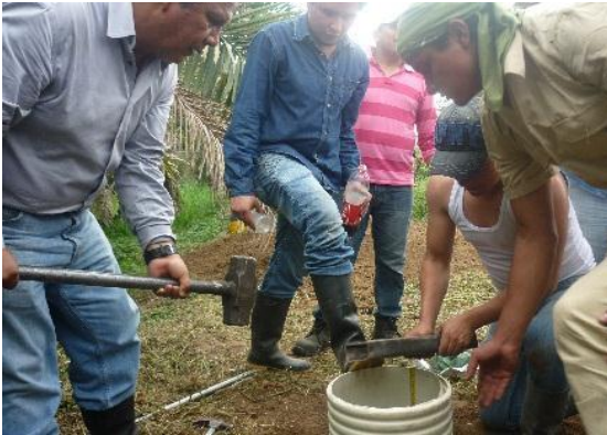
Ingreso del anillo infiltrómetro
