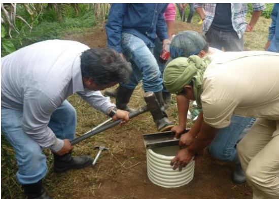
clavado del anillo infiltrómetro
