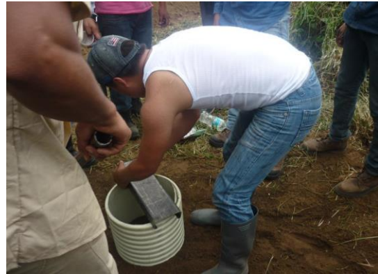
Colocación del anillo infiltrómetro
