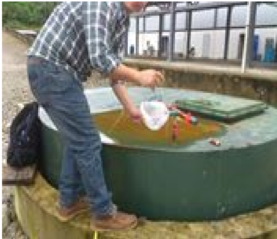
Fotografía 31 Medición del caudal del biogás
