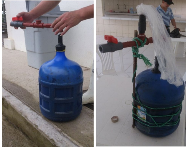
Fotografía 26 Prototipo biodigestor terminado
