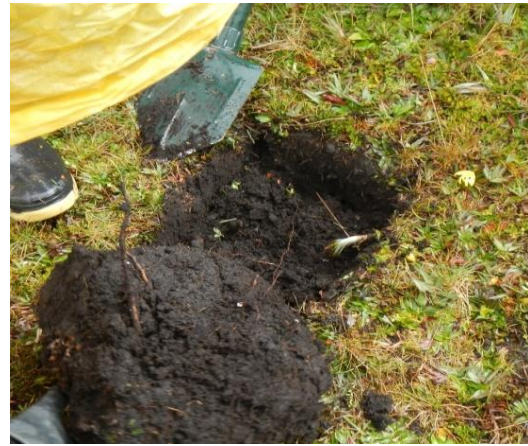
4. Excavación de la calicata
