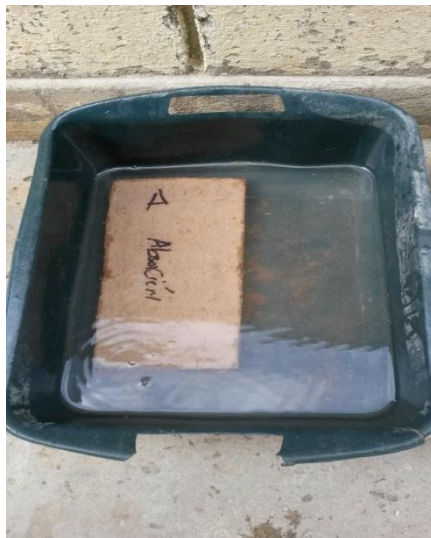
Ilustración 2-3: Ladrillo “A” en Prueba de absorción
