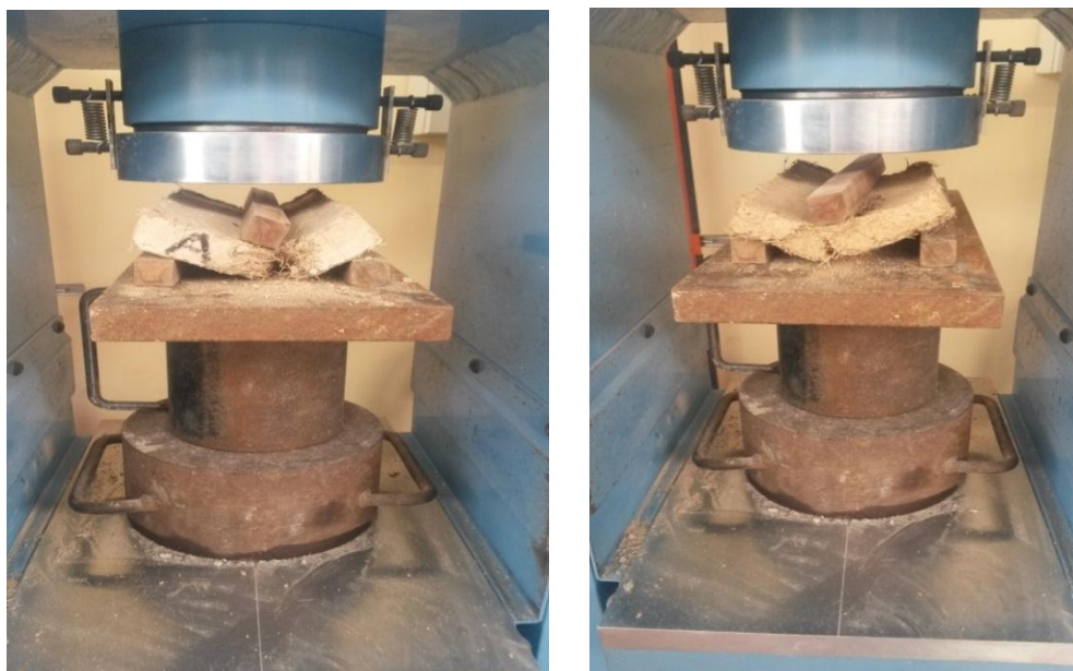
Ilustración 1-3: Rotura del ladrillo “A” y “B” en la prueba de flexión
