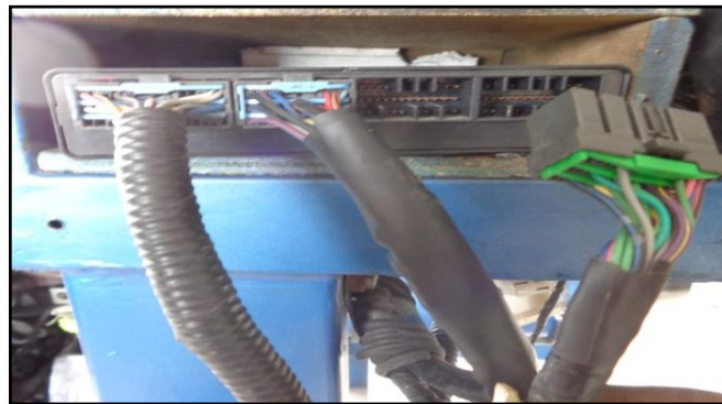
Figura 53. Instalación de la ECU
