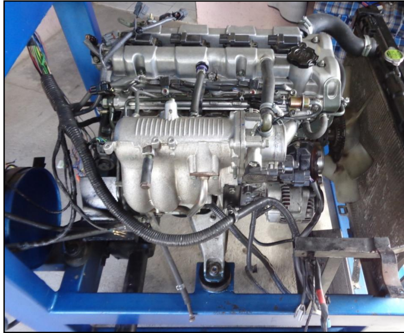
Figura 51 Arnés de cable instalado
