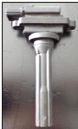
Figura 48. Bobina de encendido averiada
