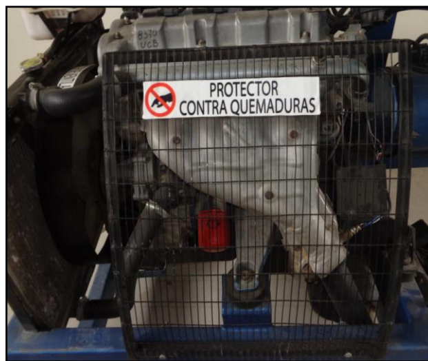
Figura 76. Malla de seguridad
