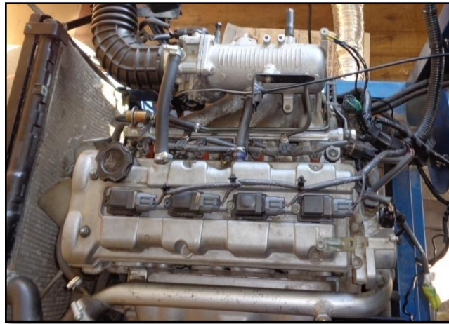
Figura 66. Cable de aceleración mecánica
