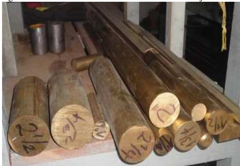
Figura 64. Selección de material Bronce fosfórico bajo SAE 640
