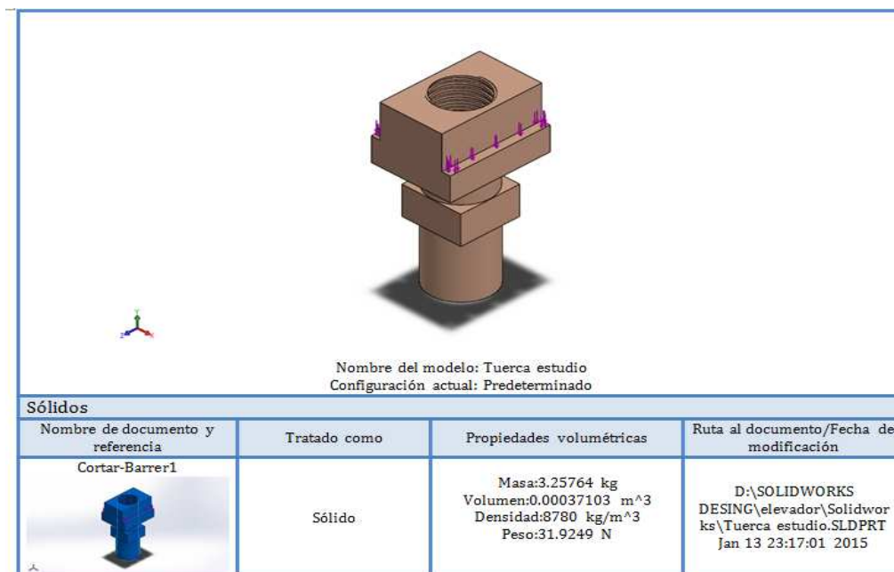
Figura 60. Análisis Tuerca de seguridad
