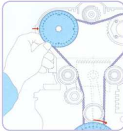
Figura 97. Calado del árbol de levas
