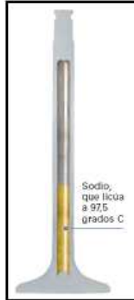
Figura 5. Válvula con alma de sodio
