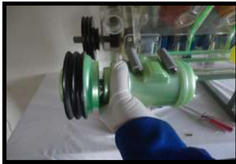
Figura 58. Compresor de aire acondicionado
