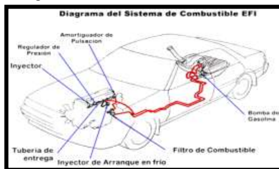
Figura 16. Sistema de combustible EFI
