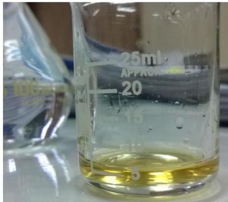
**Fotografía 9.** Ensayo de estabilidad a 40- 60 °C, separación de fases, precipitación, grado de visibilidad, auto – emulsificación, de la microemulsión formada.
