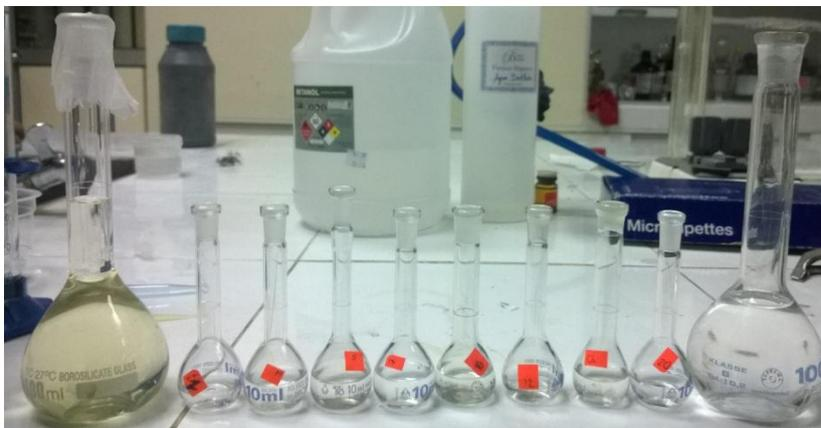
**Fotografía 7.** Ensayo de solubilidad con los diferentes vehículos, tensioactivos y co tensioactivos para la formulación óptima de la auto microemulsión.
