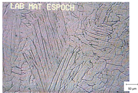
Figura 4.48: Zona de fusión. Granos de austenita. Es muy difícil apreciar la martensita existente. Atacado con ácido oxálico. Ampliación 100x.
