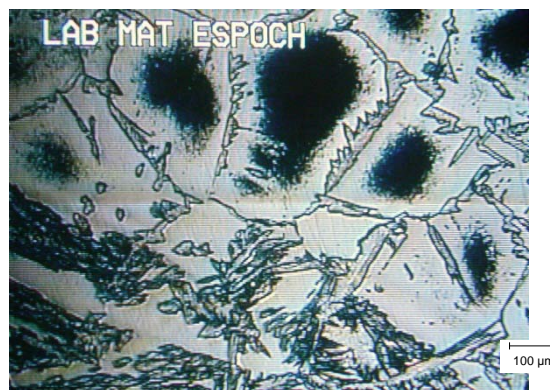
Figura 4.66: Frontera de fusión. Parte superior corresponde al acero Inox. 430. Atacado con ácido oxálico. Ampliación 50x.
