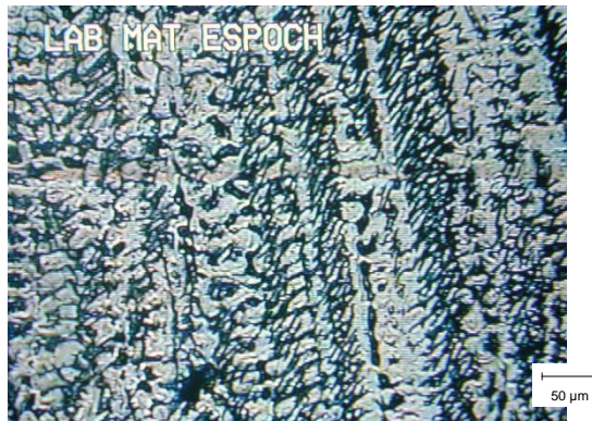
Figura 4.24: Zona de fusión. Tipo de solidificación FA con morfología de ferrita columnar y tipo placas. Atacado con ácido oxálico. Ampliación 100x
