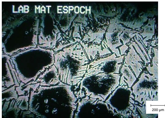
Figura 4.16: ZAC en la soldadura de un acero inoxidable AISI 430. Se pueden observar los carburos formados dentro de los granos de ferrita. Atacado con ácido oxálico. Ampliación 25x.
