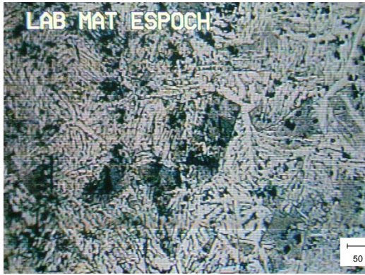
Figura 4.42: ZAC en el acero AISI 1008. Perlita media en ferrita. Atacado con nital. Ampliación 100x.
