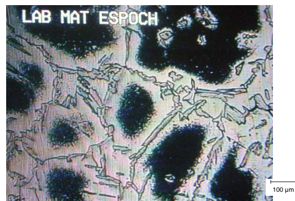
Figura 5.24: ZAC en el acero inoxidable AISI 430. Precipitación de carburos dentro del grano de ferrita, Ataque electrohídrico. Ampliación 50x.
