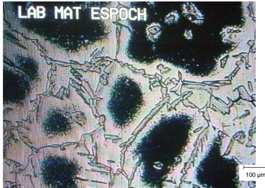
Figura 4.57: ZAC del acero inoxidable AISI 430. Ferrita bifásica rodeada de martensita en los bordes de grano. Existe además precipitación de carburos dentro del grano de ferrita. Atacado con ácido oxálico. Ampliación 50x.
