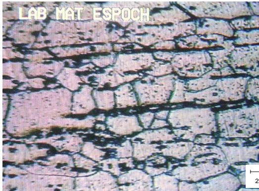
Figura 4.10: Microestructura de un acero inoxidable AISI 430. Se puede observar los precipitados de carburos (color negro). Atacado con ácido oxálico. Ampliación 200x.
