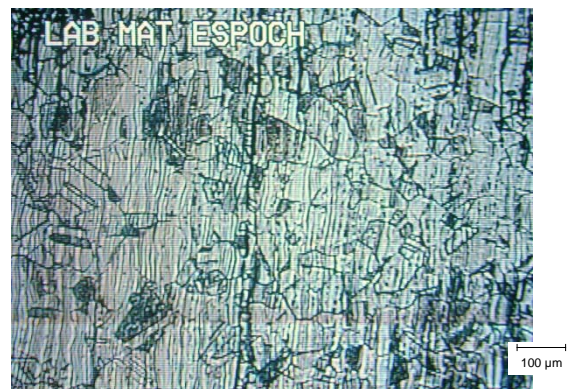
Figura 4.70: ZAC del acero inoxidable 304. Los granos austeníticos están rodeados de ferrita delta y no han crecido. Atacado electrolíticamente. Ampliación 50x.
