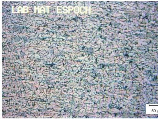
Figura 4.29: Microestructura del acero utilizado en este trabajo. Se puede observar muy poca perlita en una matriz ferrítica. Atacado con nital 2%. Ampliación 100x.
