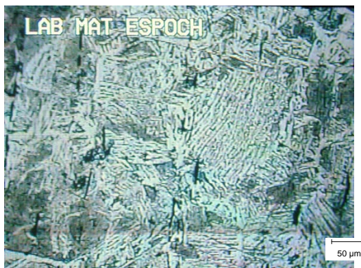
Figura 4.55: ZAC en el acero AISI 1008. Perlita media en una matriz de ferrita alfa. Atacado con ácido oxálico. Ampliación 100x.
