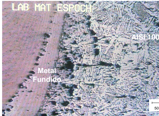
Figura 5.16. Frontera de fusión. Atacado con nital. Ampliación 100x.
