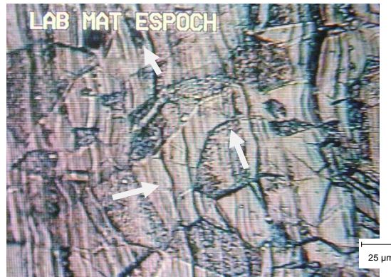
Figura 5.13: ZAC. En la estructura los pequeños puntos blancos y negros probablemente se tratan de carburos, nitruros o inclusiones. Ampliación 100x
