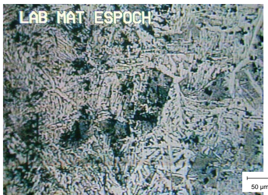
Figura 5.18: ZAC en el acero AISI 1008. Perlita media y carburos en una matriz ferrítica. Atacado con nital. Ampliación 100x.
