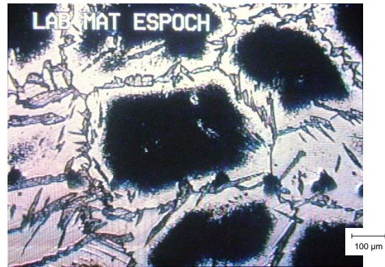
Figura 4.17: Frontera de fusión. Precipitados que se han formado en el interior del grano ferrítico con límites de grano martensítico. Precipitados %54, martensita 16 %, ferrita 30 %. Ataque electrofítico. Ampliación 50x.
