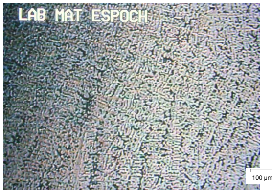
Figura 4.33: Zona de fusión. Solidificación tipo AF, posee ferrita eutéctica en una matriz austenítica. Atacado con ácido oxálico. Ampliación 50x.
