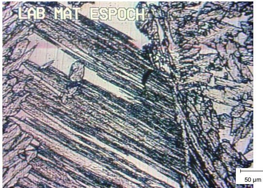
Figura 5.25: Zona de fusión. Las líneas negras en completo desorden son ferrita en una matriz austenítica. Ampliación 100x
