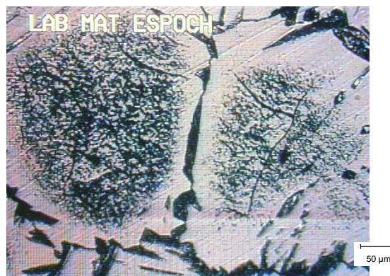
Figura 4.14: Zona de Fusión. Granos de ferrita bifásica. En el centro del grano las partes negras corresponden a carburos o precipitados. Atacado con ácido oxálico. Ampliación 100x.
