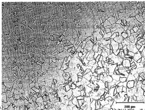
Figura 4.20: Microestructura de una placa de acero inoxidable tipo 304. Completamente austenítico [8]
