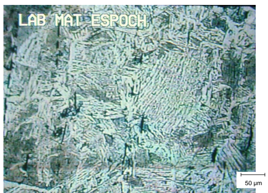
Figura 5.23: ZAC en el acero AISI 1008. Puede verse la presencia de perlita en una matriz ferrítica. Ampliación 100x
