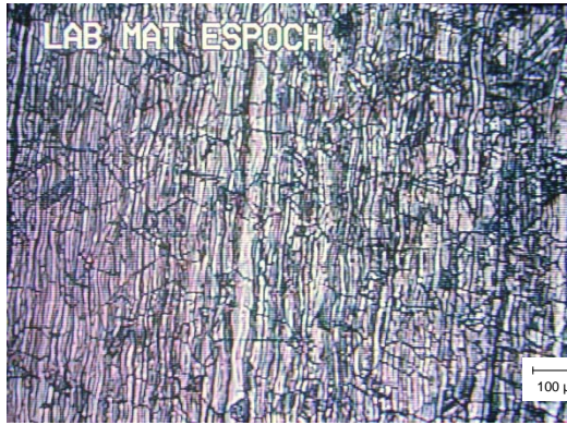
Figura 4.18: Acero inoxidable austenítico 304. Granos de austenita con presencia de ferrita delta alineada con la dirección de laminado. Atacado con ácido oxálico. Ampliación 50x.
