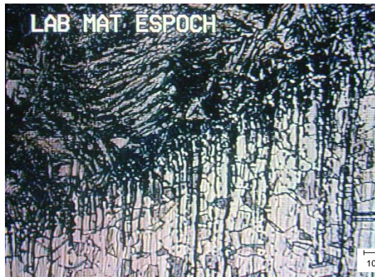
Figura 4.67: Frontera de fusión cercana al acero inoxidable 304. La ferrita se extiende desde la zona de fusión hacia la ZAC. Atacado con ácido oxálico. Ampliación 50x.
