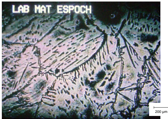
Figura 4.12: Zona de Fusión de la junta AISI 430-AISI 430. Se puede observar granos de ferrita rodeada por Martensita en los bordes de grano. Atacado con ácido oxálico. Ampliación 25x.
