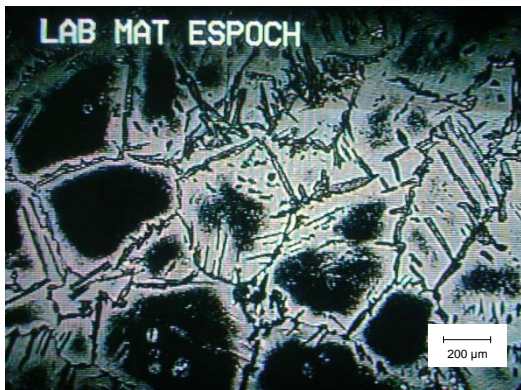
Figura 5.3: ZAC en la soldadura de un acero AISI 430. Se pueden observar los precipitados (color negro) dentro de los granos de ferrita. Atacado con ácido oxálico. Ampliación 25x.
