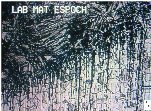
Figura 5.28: Frontera de fusión cercana al acero inoxidable 304. Ampliación 50x.
