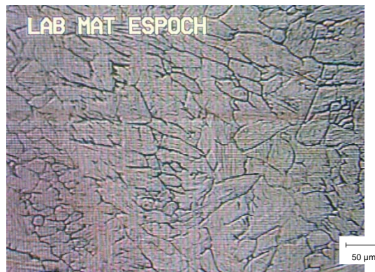
Figura 5.20: Zona de fusión. Granos austeníticos. Atacado con ácido oxálico. Ampliación 100x
