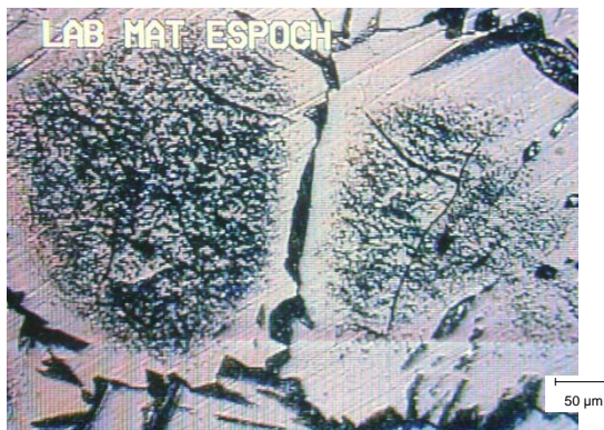
Figura 5.1: Zona de fusión. Ferrita con bordes de grano martensítico. En el centro del grano las partes negras corresponden a precipitados. Atacado electrolítico. Ampliación 100x.
