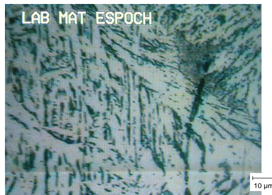
Figura 4.56: ZAC con mayor ampliación. Atacado electroquímicamente con ácido oxálico. Ampliación 400x
