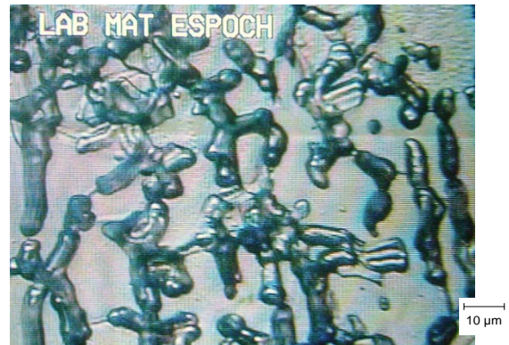
Figura 4.25: Zona de fusión. Tipo de solidificación FA. Morfología de ferrita (negra). Atacado con ácido oxálico. Ampliación 400x
