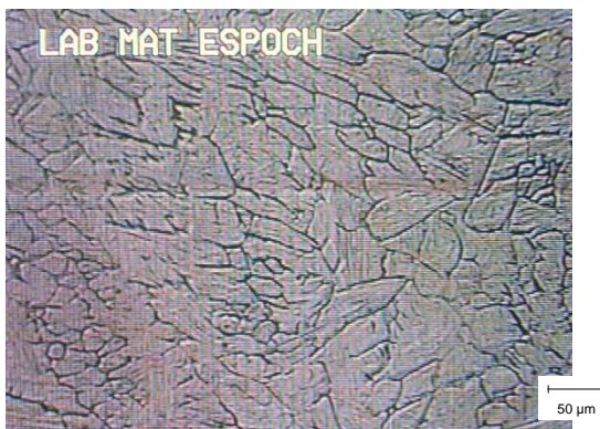
Figura 4.47: Zona de fusión. Granos austeníticos. Atacado con ácido oxálico. Ampliación 100x
