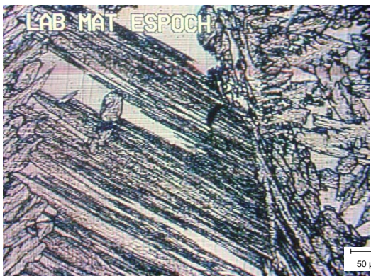
Figura 4.62: Zona de fusión. Las líneas negras en completo desorden son ferrita. Atacado con ácido oxálico. Ampliación 100x
