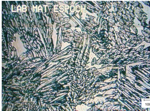
Figura 4.60: Zona de fusión. Estructura formada de austenita y ferrita (líneas negras) en completo desorden. Atacado con ácido oxálico. Ampliación 50x.
