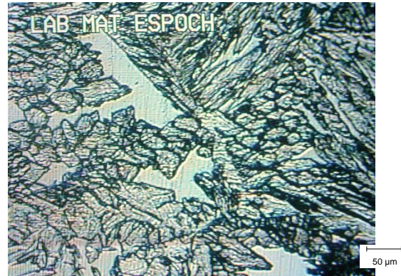
Figura 4.61: Zona de fusión. Igual a la figura anterior con mayor acercamiento. Ampliación 100x.
