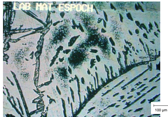
Figura 4.13: Zona de Fusión. Pequeñas cantidades de precipitados (color negro) dentro de los granos ferríticos. Atacado con ácido oxálico. Ampliación 50x.
