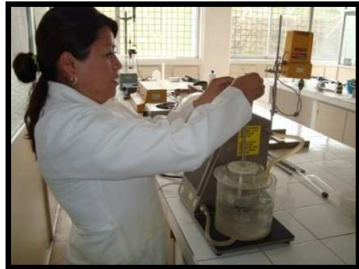
FOTOFRAFÍA No 12. CONTROL DE CALIDAD DE LOS COMPRIMIDOS DE AJENJO, ROMERO Y MANZANILLA. FRIABILIDAD, DUREZA Y DESINTEGRACIÓN. REALIZADO EN LA PLANTA PILOTO UNIVERSIDAD CENTRAL DEL ECUADOR. NOVIEMBRE 2009
