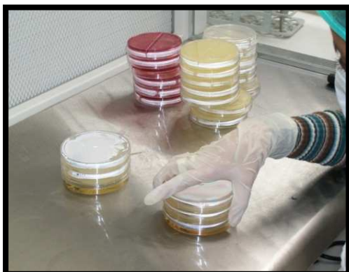
FOTOFRAFÍA No.13 RESULTADO DE LA DETERMINACIÓN DE MICROORGANISMOS CONTAMINANTES DE LOS COMPRIMIDOS DE 700 mg. REALIZADO EN LA PLANTA PILOTO DE LA UNIVERSIDAD CENTRAL DEL ECUADOR. QUITO NOVIEMBRE 2009.
