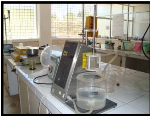
FOTOFRAFÍA No 12. CONTROL DE CALIDAD DE LOS COMPRIMIDOS DE AJENJO, ROMERO Y MANZANILLA. FRIABILIDAD, DUREZA Y DESINTEGRACIÓN. REALIZADO EN LA PLANTA PILOTO UNIVERSIDAD CENTRAL DEL ECUADOR. NOVIEMBRE 2009
