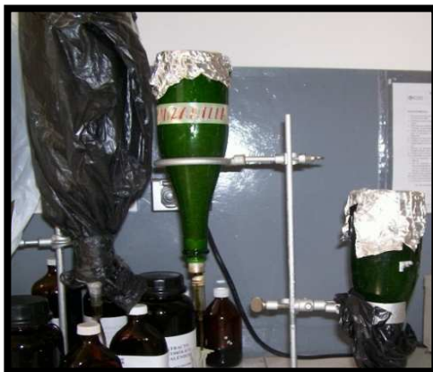
FOTOGRAFIA Nº 7 MÉTODO DE PERCOLACIÓN PARA LA OBTENCIÓN DE LOS EXTRACTOS
