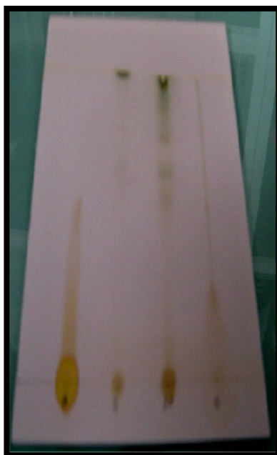
FOTOFRAFÍA No 4. PLACA CROMATOGRÁFICA DE LA MEZCLA DE EXTRACTO DE AJENJO, ROMERO Y MANZANILLA. PARA LA DETECCIÓN DE FLAVONOIDES, UTILIZANDO COMO ADSORBENTE: SÍLICA GEL 60 F 254 (MERCK). FASE MÓVIL: CLOROFORMO-ACETONA-ÁCIDO FÓRMICO (75:16.5:8.5). REVELADO: ÁCIDO SULFÚRICO - VAINILLINA (8:4). (24)
