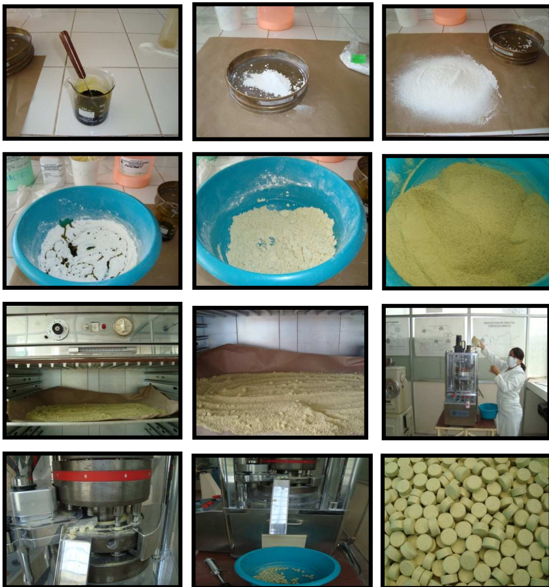
FOTOFRAFÍA No11. ESQUEMA DE ELABORACIÓN DE LOS COMPRIMIDOS DE AJENJO, ROMERO Y MANZANILLA. REALIZADO EN LA PLANTA PILOTO UNIVERSIDAD CENTRAL EL ECUADOR. NOVIEMBRE 2009.
