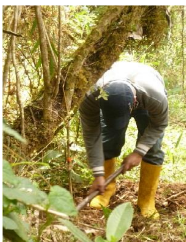
5. Realización de las calicatas
