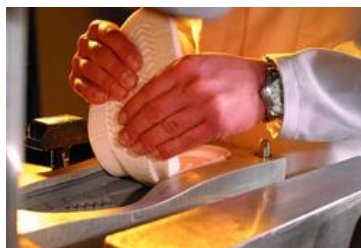
FIG. 2 Retiro de suela del molde
