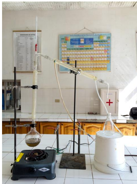
FOTOGRAFÍA 5 Prueba de destilación fraccionada
