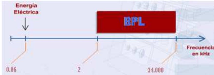
Figura III.11. Rango de Frecuencia utilizada por BPL.
