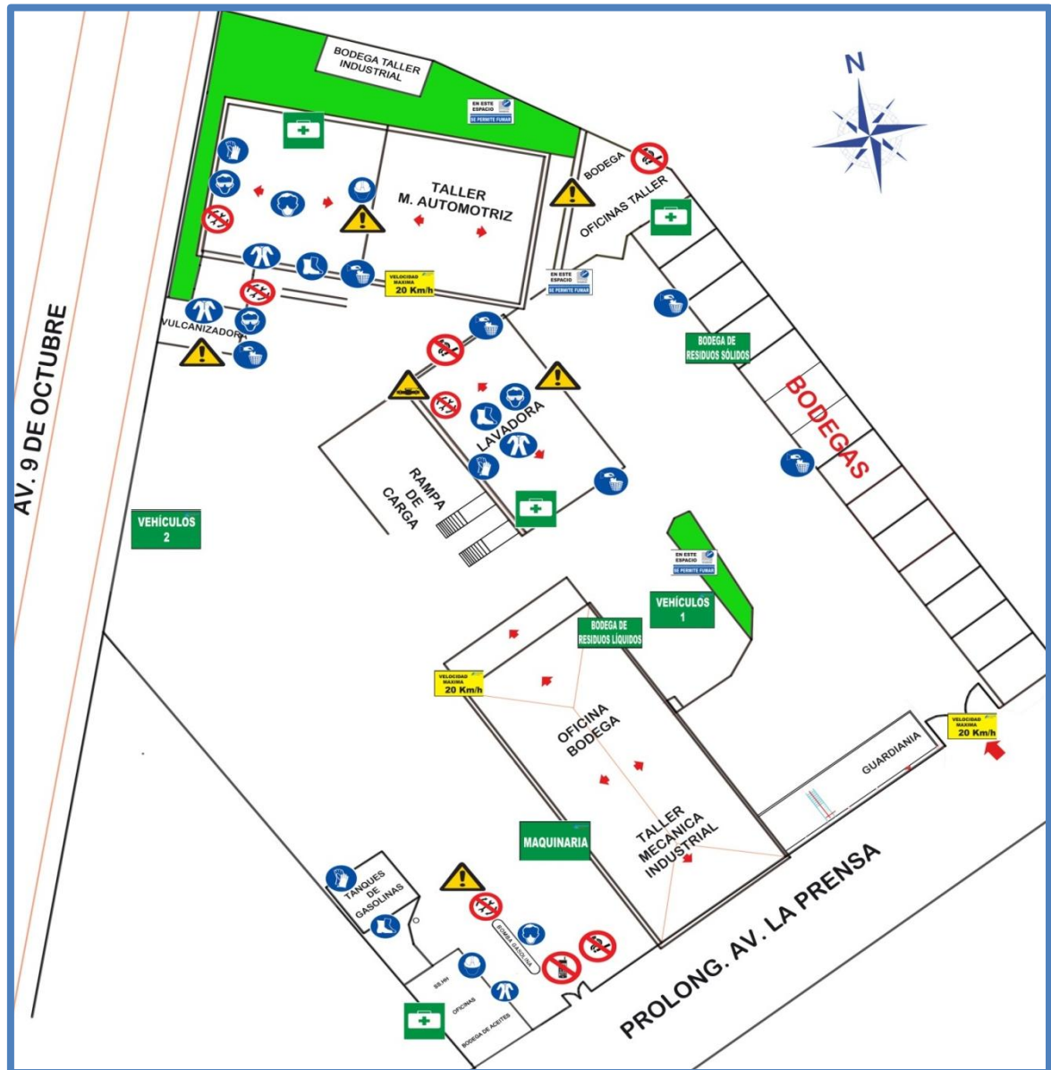
Figura 5.3: Ubicación de las señales de seguridad
