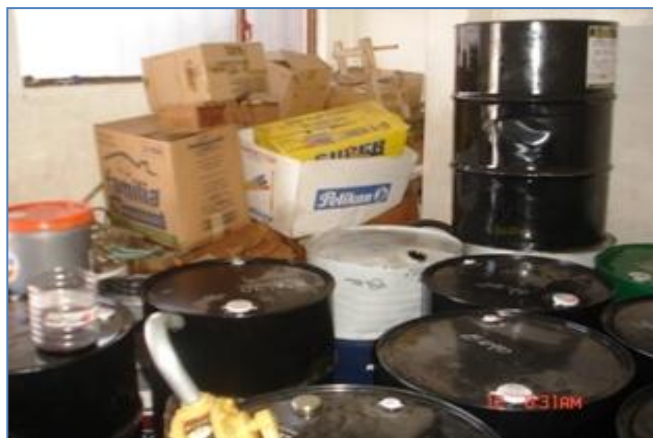
Figuras 3.17. Inadecuado almacenamiento de lubricantes.
