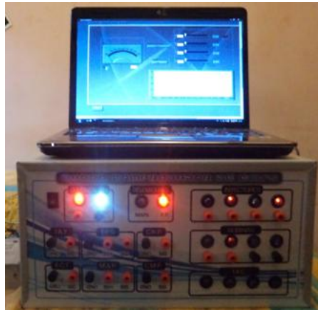
Figura 5.13 Prueba de funcionamiento del la ECU del vehículo CHEVROLET LUV D-MAX con el BCECU
