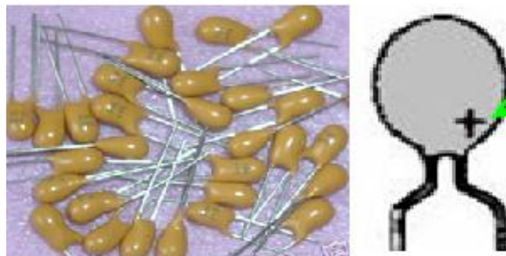
Figura 3.10 Esquema del capacitor de tantalio [11]
