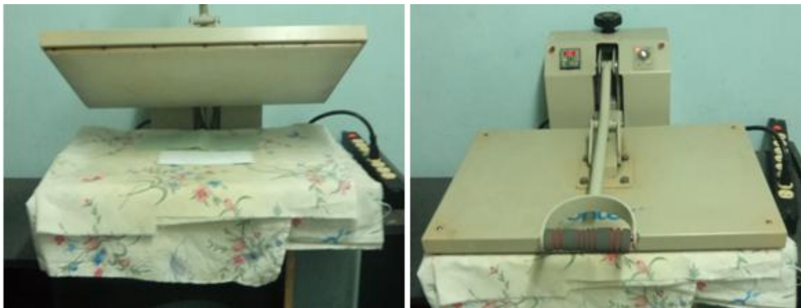
Figura 4.10 Estampado de los circuitos impresos
