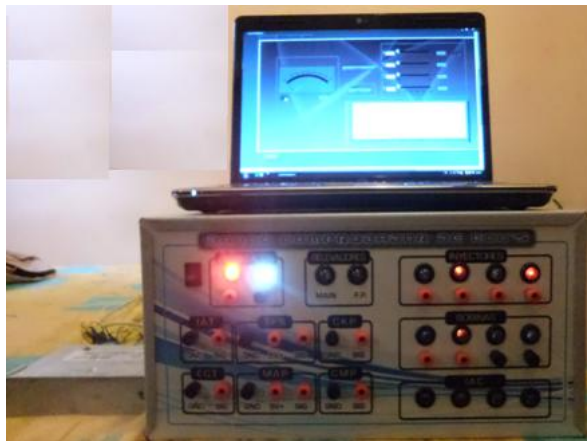
Figura 5.11 Prueba de funcionamiento de la ECU del vehículo CHEVROLET CORSA con el BCECU
