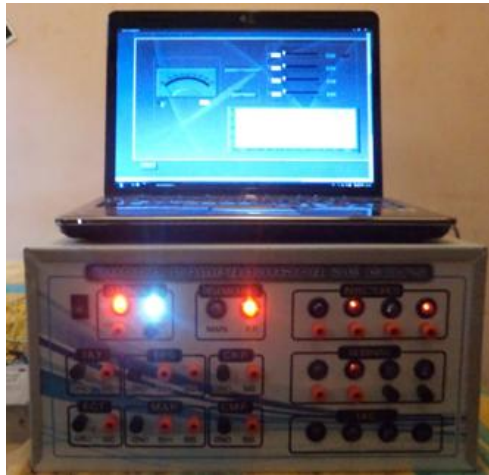
Figura 5.14 Prueba de funcionamiento del la ECU del vehículo CHEVROLET SPARK con el BCECU
