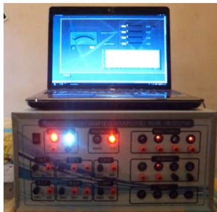
Figura 5.12 Prueba de funcionamiento del la ECU del vehículo CHEVROLET LUV 2.2 con el BCECU
