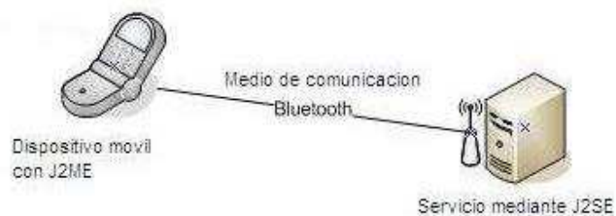
Figura III. 1. Estructura básica de la arquitectura del sistema, APORTE A JAVA (16).
