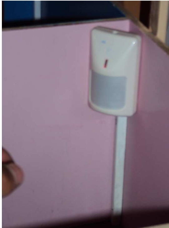
Figura V.86 Disposición de Sensor Detector de Presencia
