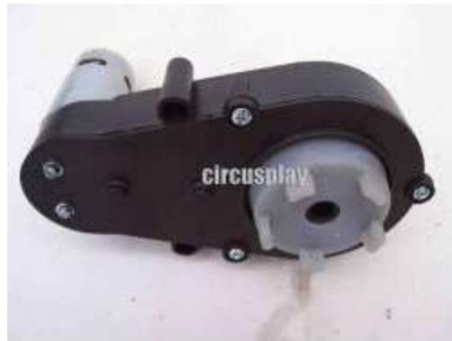
Fig. II.30.- Motor de CC con caja de engranaje del robot
