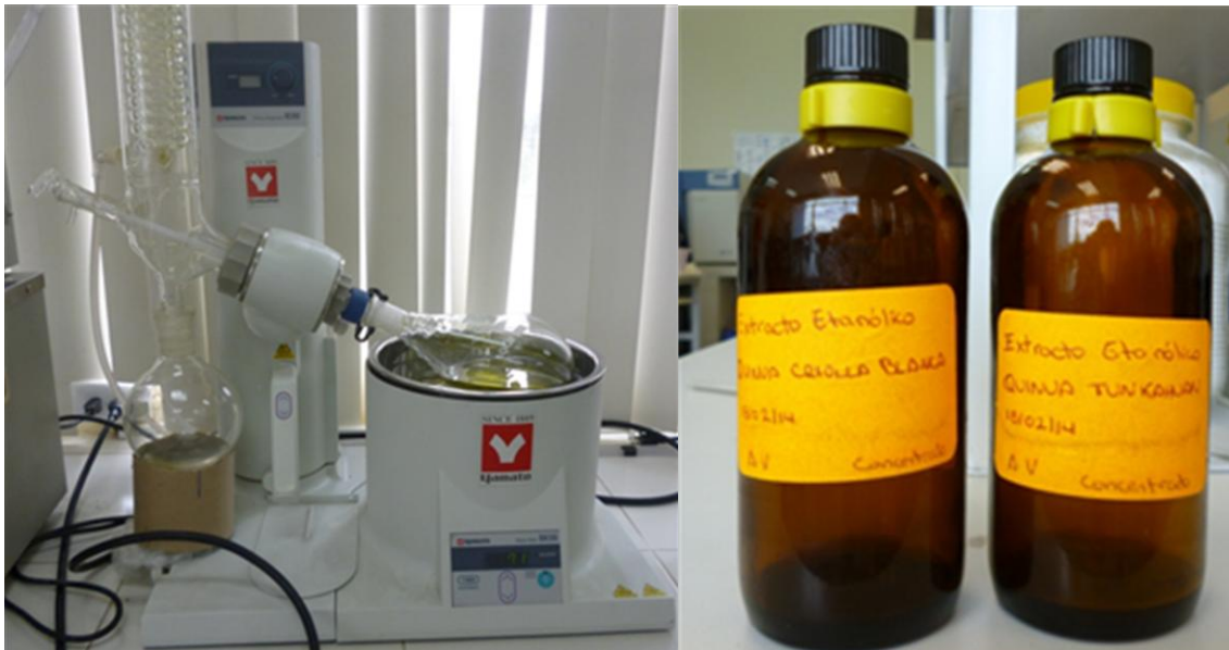
FOTOGRAFÍA N° 3: CONCENTRACIÓN DEL EXTRACTO ETANÓLICO DE QUINUA CRIOLLA BLANCA Y QUINUA TUNKAHUAN
