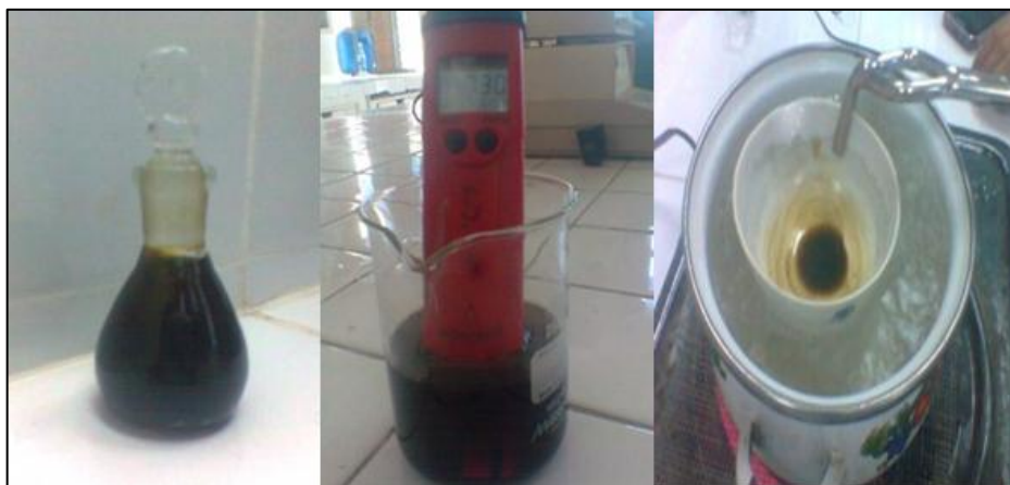
FOTOGRAFÍA No 11. CONTROL DE CALIDAD FÍSICO-QUÍMICO PARA Physalis peruviana : Densidad, pH y Sólidos totales.
