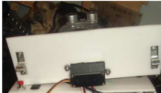
Figura 10. Servomotor que permite el Movimiento Horizontal
