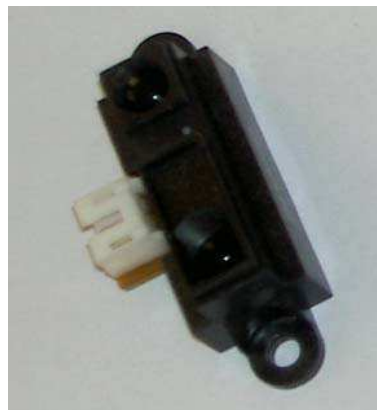
Figura II.12. Aspecto externo de un Sharp GP2Y0A21YK
