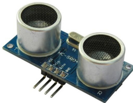
Figura II-17: Sensor ultrasónico HC-SR04.
