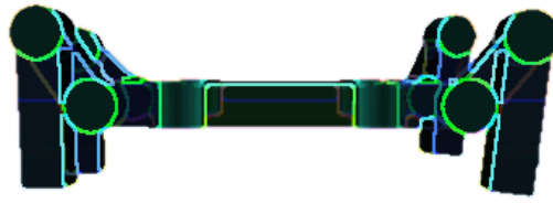
Figura II-9: Configuración de patas tipo arácnido para robots cuadrúpedos.
