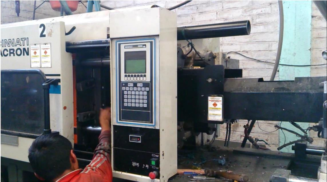
*Figura III-49: Apertura del CLAMP y Puerta*
