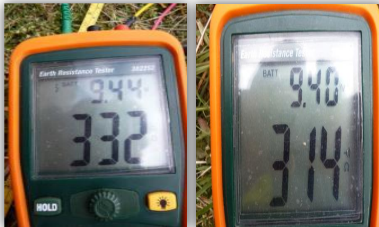
Figura IV.70. Mediciones de resistividad realizadas con el telurómetro Fuente: Janeth Camacho (Autora)
