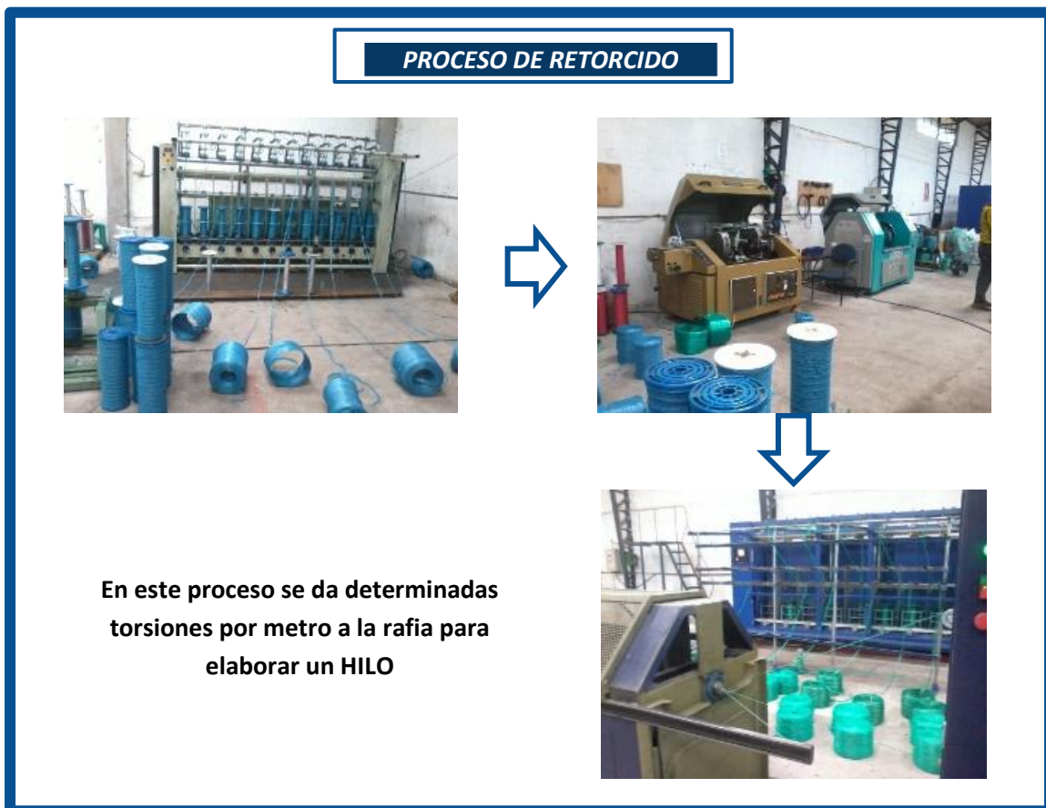
Fuente: Janeth Camacho (Autora) Figura I. 2. Maquinaria para retorcido
