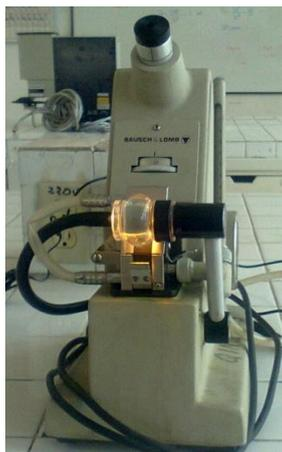
FOTOGRAFÍA N°7 Refractómetro
