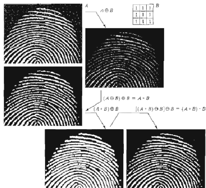
Figura IV.31. a) Imagen con ruido, b) Elemento estructurado, c) Imagen erosionada, d) Apertura de A, e) Dilatación de la apertura, f) Cierre de la apertura.
