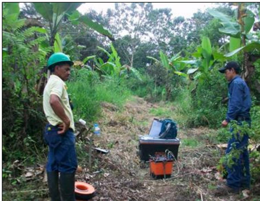
**Foto 1:** Instalación del equipo de resistividad eléctrica
