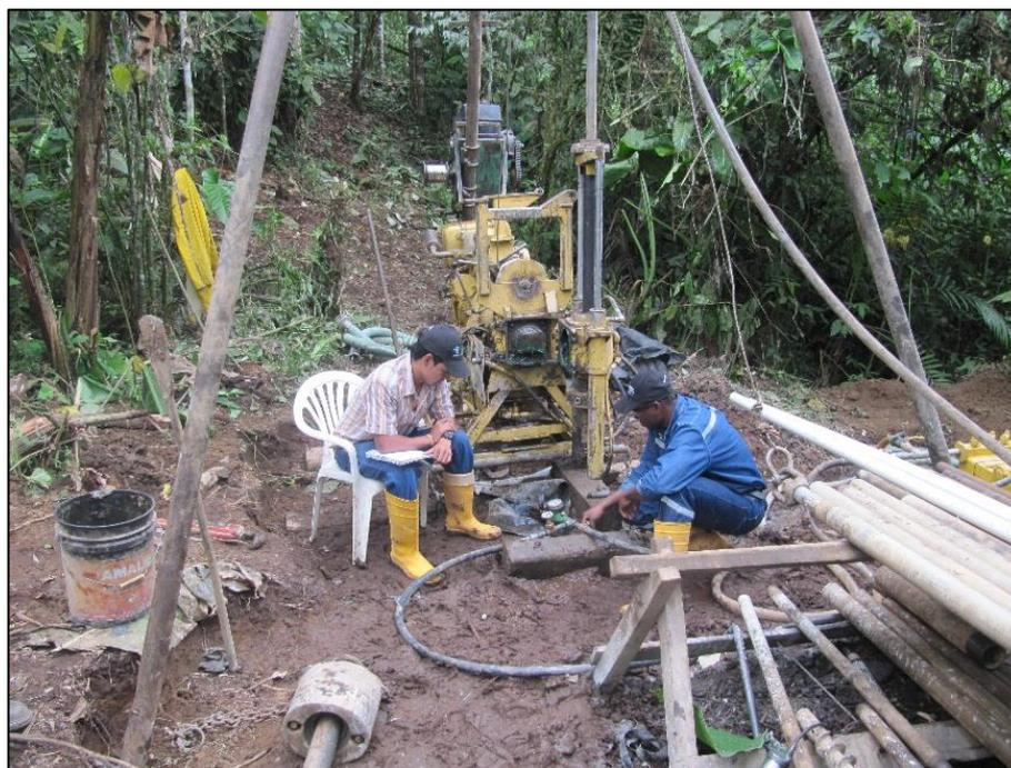
**Foto 7:** Ensayo Lefranc en el Sondeo P2
