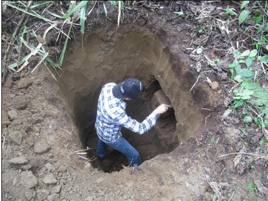
**Foto 10:** Extracción de Muestras Inalteradas
