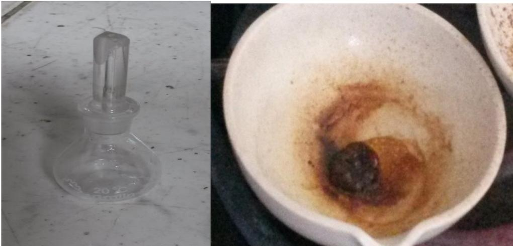
**FOTOGRAFÍA No. 12. DETERMINACIÓN DE PARÁMETROS FÍSICOS DEL EXTRACTO HIDROALCOHÓLICO: DENSIDAD, SÓLIDOS TOTALES.**
