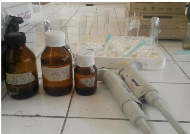
**FOTOGRAFÍA No. 17. REACTIVOS Y MATERIALES UTILIZADOS EN LA CUANTIFICACIÓN DE FLAVONOIDES TOTALES**
