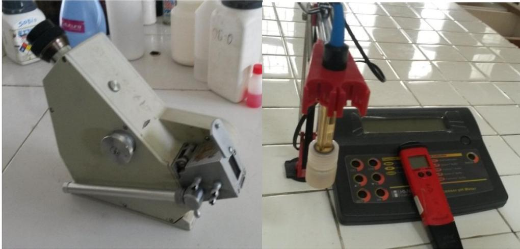
**FOTOGRAFÍA No. 11. DETERMINACIÓN DE PARÁMETROS FÍSICOS DEL EXTRACTO HIDROALCOHÓLICO: INDICE DE REFRACCIÓN, pH.**
