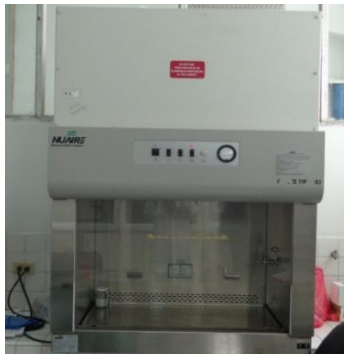
Cámara de flujo laminar
