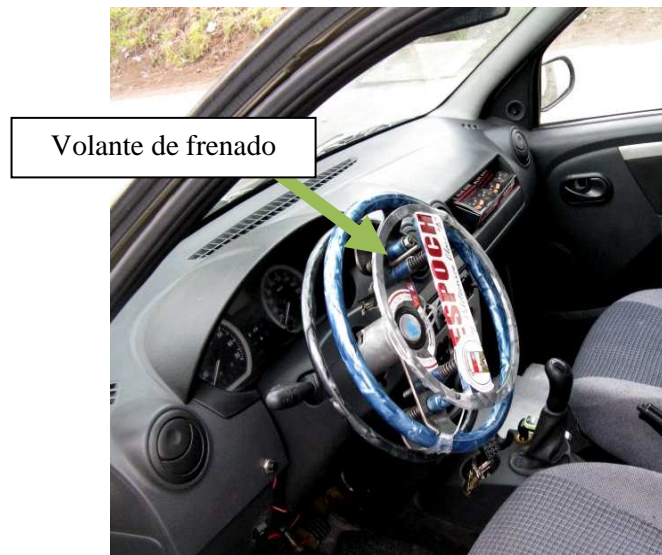
Figura 79. Accionamiento del freno
