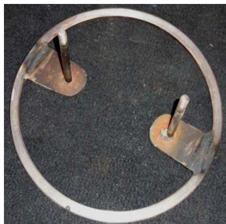
Figura 55. Construcción del volante de frenado
