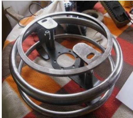
Figura 37. Fotografía sistema de accionamiento del acelerador y freno
