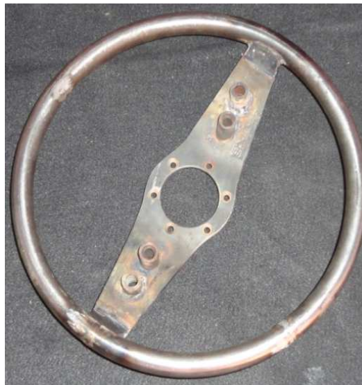
Figura 43. Construcción del volante de la dirección
