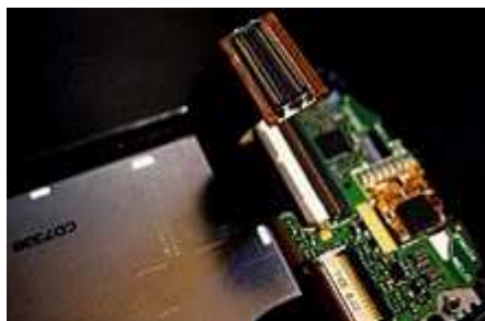
Figura 23. Utilización del cable plano flexible
