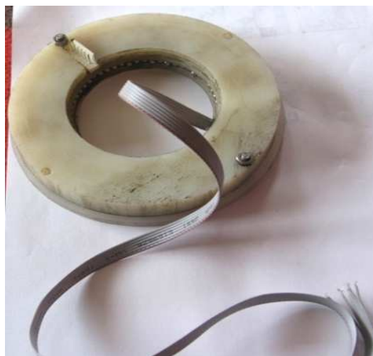
Figura 68. Construcción de la rueda transmisora de datos
