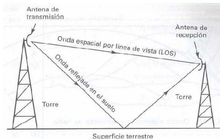
Figura II.6 Propagación de ondas espaciales.
