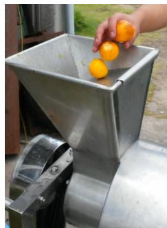
Figura 103. Forma correcta de colocar la fruta en la tolva
