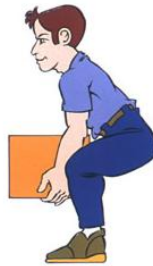
Figura 100. Forma correcta de levantamiento de cargas
