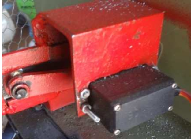
Figura 57. Servomotor adaptado al mecanismo
