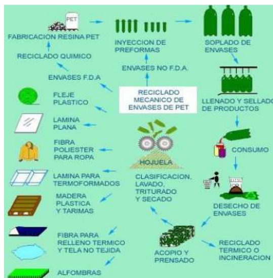
Figura 5. Reciclado mecánico de envases PET.
