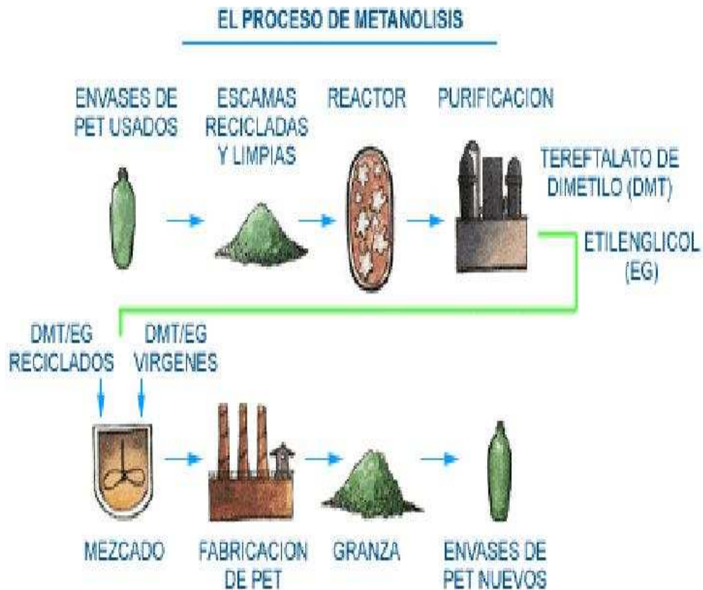
Figura 3. Reciclado químico de metanólisis.
