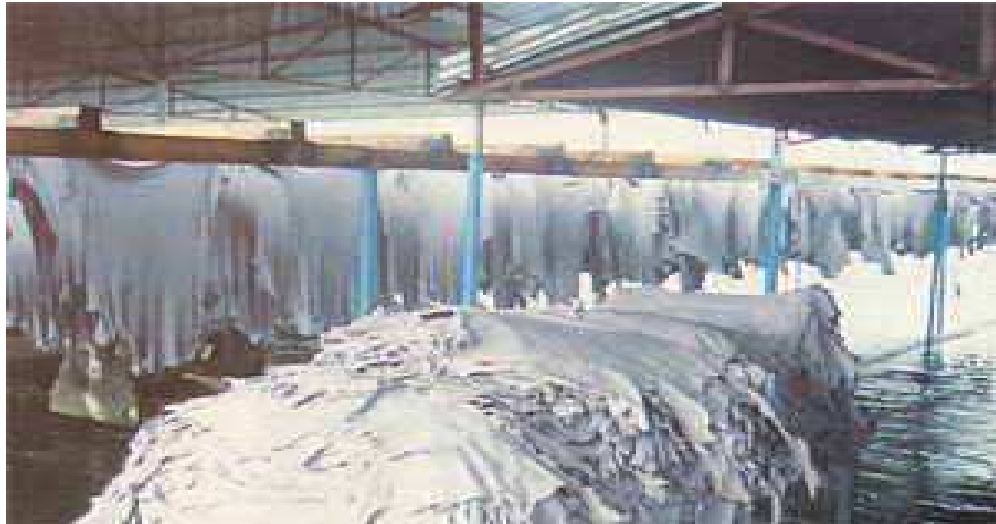
Figura 4. Cámara de secado
