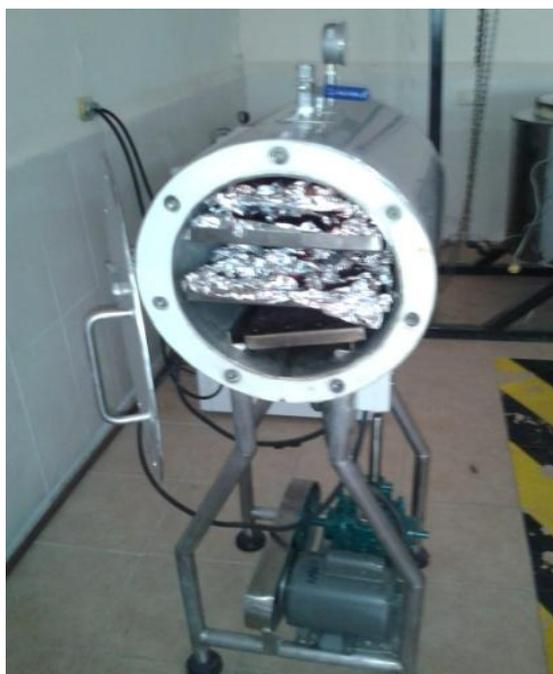
**MUESTRA LISTA PARA SER PROCESADA EN SECADOR DE BANDEJAS, LABORATORIO DE PROCESOS INDUSTRIALES, ESPOCH.**
